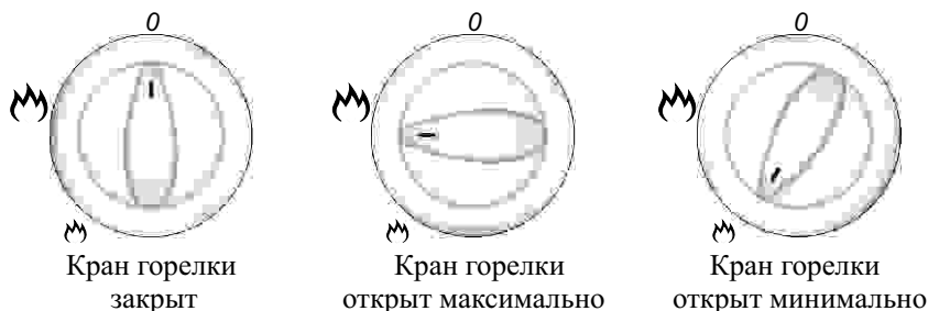
Рисунок 7.1 - Возможные положения ручек кранов газовых горелок.
